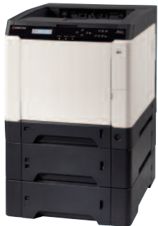
El modelo FS-C5250DN con dos bandejas de papel adicionales para una capacidad de papel de 1000 hojas
